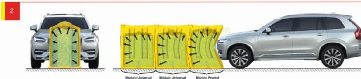
Desde el momento en el que el vehículo hace contacto con el primer módulo se inicia el amortiguamiento, el contenedor exterior se deforma y puede llegar a romperse, los contenedores flexibles interiores se aplastan, el agua se desplaza y hace que los contenedores flexibles interiores tomen la forma de la parte frontal del vehículo envolviéndolo.
