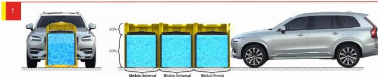
El ensamble de los contenedores flexibles interiores de cada módulo, se llena con agua hasta el 80% de la capacidad del contenedor exterior, se extrae el aire que queda en el ensamble de los contenedores flexibles interiores, se cierran herméticamente mediante una tapa con válvula de alivio de presión y se plega el ensamble al interior del contenedor exterior.
