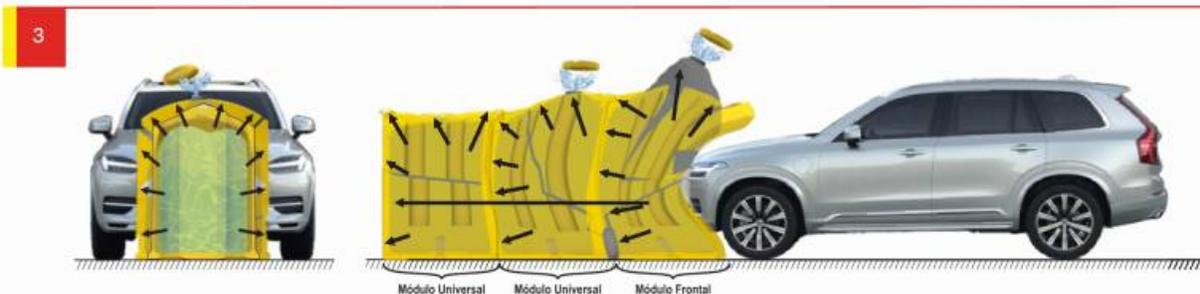
Si la presión ejercida durante el impacto es muy alta, se abre la válvula de alivio de presión y deja salir el agua de manera controlada, de este modo se libera parte de la presión ejercida sobre el agua y se alarga el tiempo de contacto entre el vehículo y el sistema de triple contenedor.
