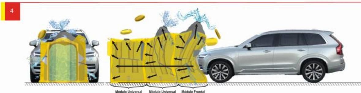
Si durante el impacto se perfora el ensamble de los contenedores flexibles, el agua sale por las perforaciones, liberando parte de la presión ejercida sobre el agua, pero el ensamble no se revienta, de esta manera se incrementa la capacidad de amortiguamiento del impacto.
