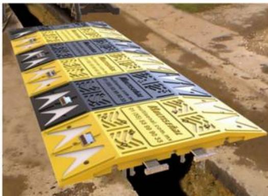
Con ayuda de un taladro con broca de 3/4" para concreto, marcamos todos los barrenos del reductor, marcamos todos los barrenos del reductor, sirviéndonos como plantilla el mismo, perforamos el área asignada a una profundidad de 7"; introducimos los taquetes en los barrenos, ensamblamos el reductor, después insertamos los tornillos y rondanas planas de 3/8", con la ayuda de un dado 9/16" y finalmente apretamos los tornillos.
