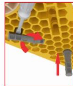
Colocación de pernos
