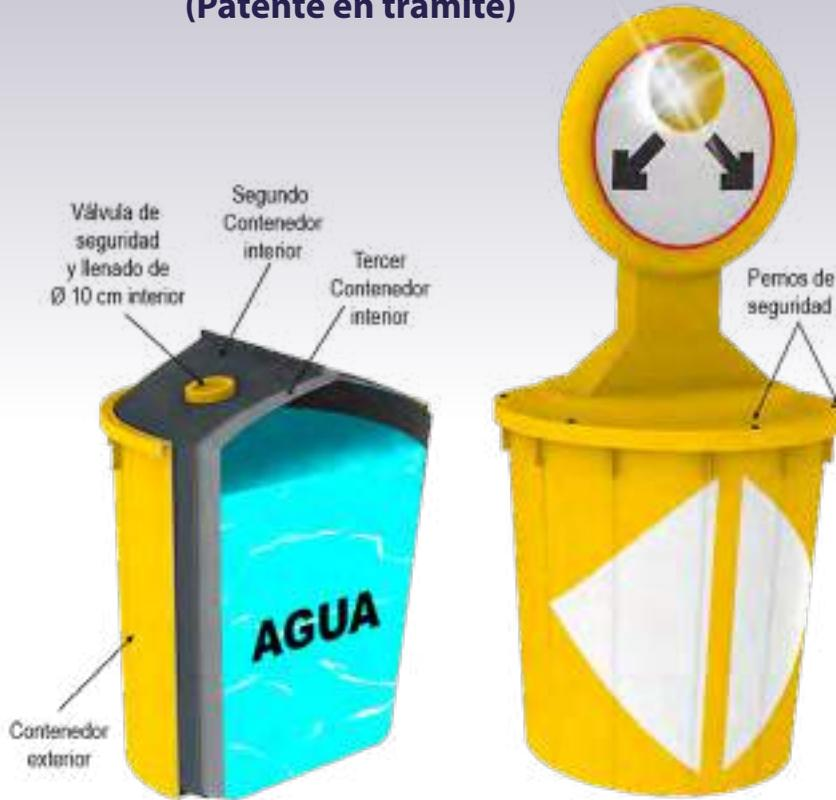
No hay pérdida de agua por evaporación, el vapor de agua se condensa adentro del tercer contenedor interior y recupera su volumen original.
