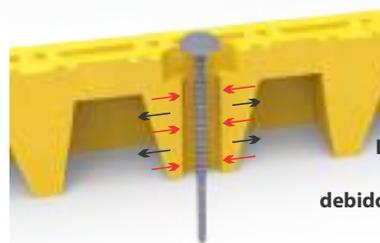
El barreno oval está diseñado para que no se salga el ancla, debido a la dilatación y contracción que sufre el bolardo por la temperatura ambiente.
