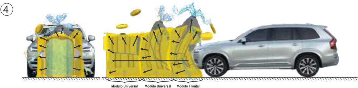
Si durante el impacto se perfora el ensamble de los contenedores flexibles, el agua sale por las perforaciones liberando parte de la presión ejercida sobre el agua pero el ensamble no se revienta, de esta manera se incrementa la capacidad de amortiguamiento del impacto.
