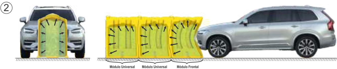
Desde el momento en el que el vehículo hace contacto con el primer módulo se inicia el amortiguamiento, el contenedor exterior se deforma y puede llegar a romperse, los contenedores flexibles interiores se aplastan, el agua se desplaza y hace que los contenedores flexibles interiores tomen la forma de la parte frontal del vehículo envolviéndolo.
