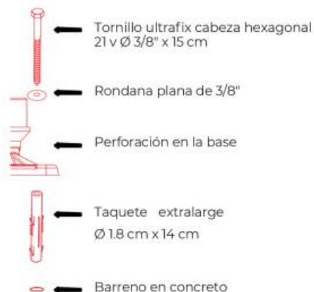
Anclaje Tornillo "Ultrafix" cabeza hexagonal Ø 3.8" x 15 cm Taquete "Extralarge" Ø 1.8 cm x 14 cm.
